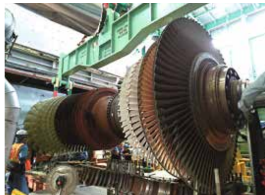
複循環機組的轉軸葉片。
