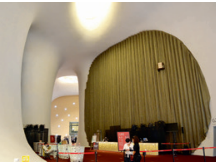
▲ 2 樓劇場曲牆上一塊巨大的布幕，是模擬洞穴裡的樹皮，而布幕上像鳥巢的箱子則是消防灑水設備。
