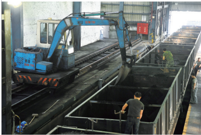
▲ 運煤火車卸煤作業。
