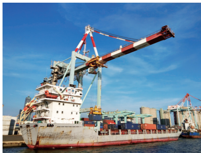
▲ 負責港區裝卸貨櫃的橋式起重機。
