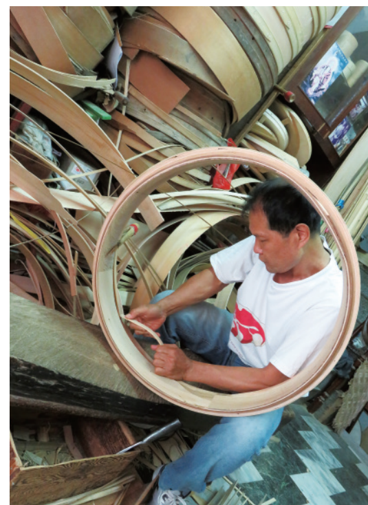
▲ 利用第二緣木邊強固蒸籠邊框，圖為製作蒸籠底座的王開弘。
