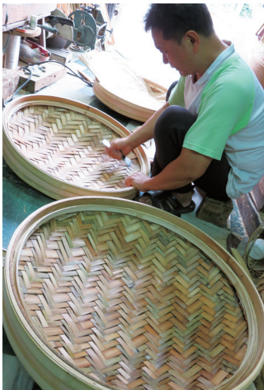
▲ 負責製作蒸籠上蓋的王炳文，正在固定蒸籠上蓋的竹片與邊框。
