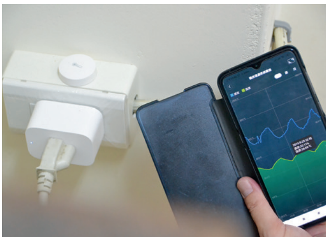
▲ 張校長在學校的電腦機房和階梯教室安裝了智能省電裝置，只不過是在原有插座上多加了一個白色的轉接插頭和一個溫溼度感應器，就可以通過手機來監控。
