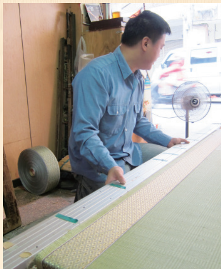
▲ 切割修整後，用壓尺確定平整度。
